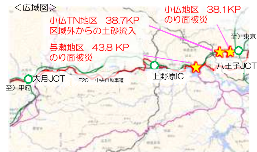
被災状況 (R1.10) 被災・復旧状況 (与瀬地区 43.8 KP) 復旧作業状況 (R2.10)
