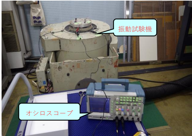
図 18 振動試験機を用いた振動発電デバイス評価概略
