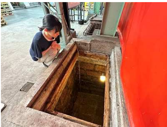
石蔵発酵槽（大量のワインの仕込みタンクとして、今も利用されています。）
