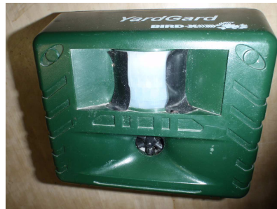
図 2 実験に用いた音を利用した赤外線センサー付忌避資材（縦・横・奥行 13×16×8cm）
