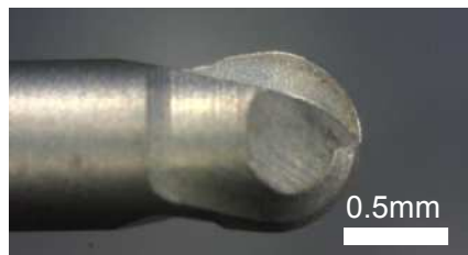
図2 切削工具外観
