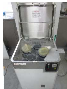
図 2 遠心バレル研磨機
