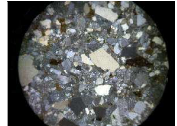
図.1 岩殿山の砂岩礫の偏光顕微鏡写真
