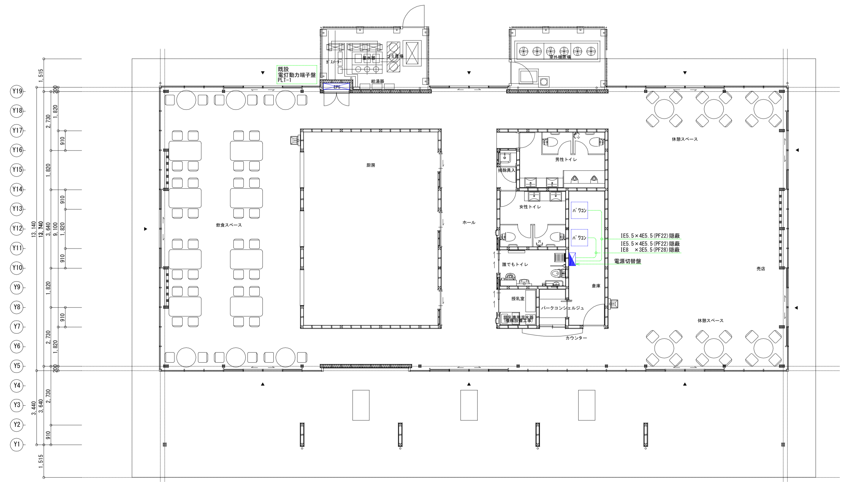
非常電源設備平面図 S=1:100
