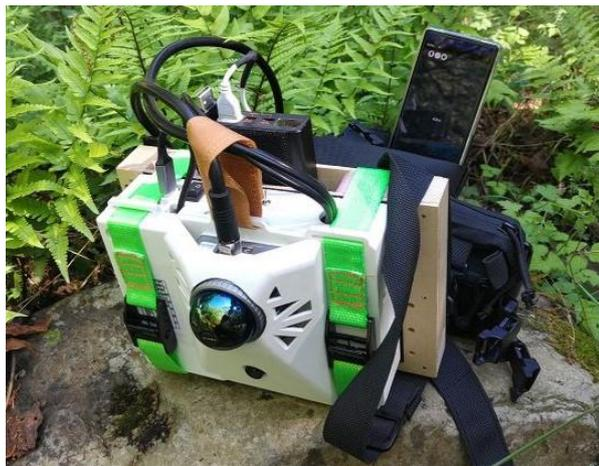
写真1 簡易LiDAR計測機
