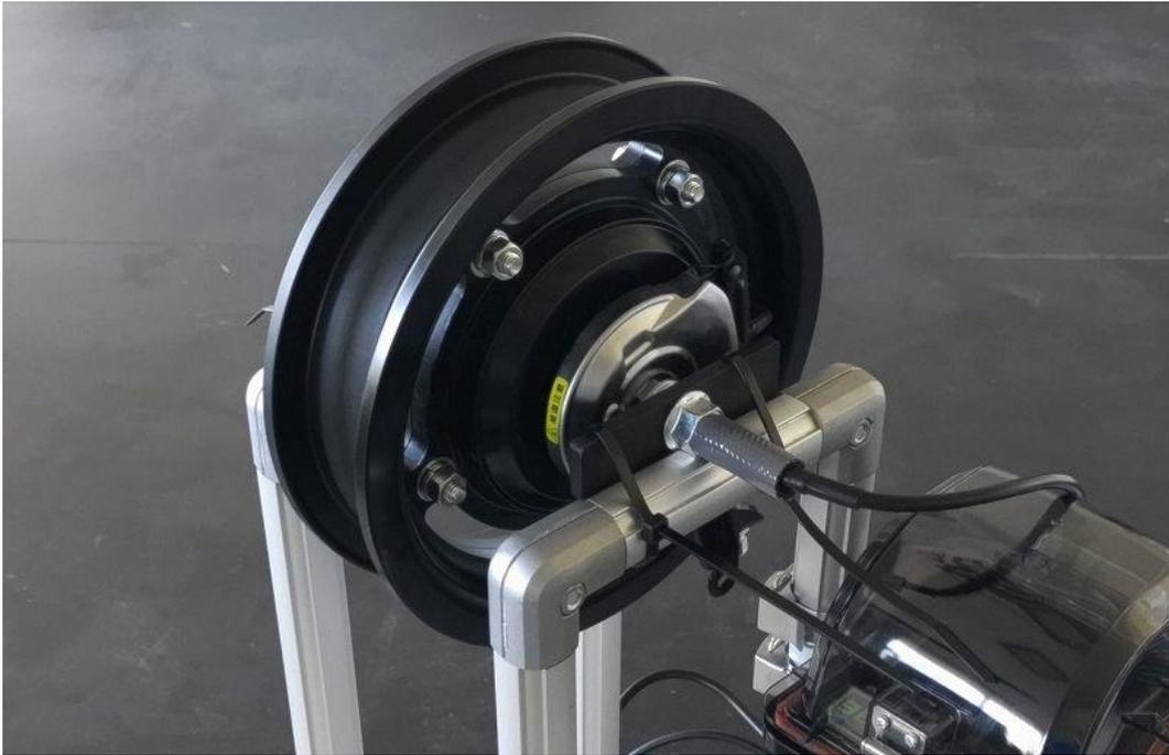
写真1 主動力の電動ホイールハブモータ動作試験
