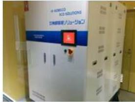
水電解式高純度水素発生装置
