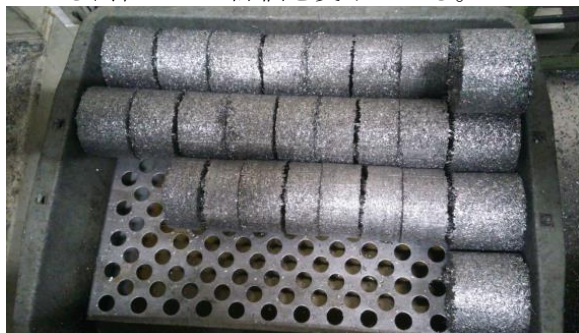
圧縮機で圧縮された金属くず
