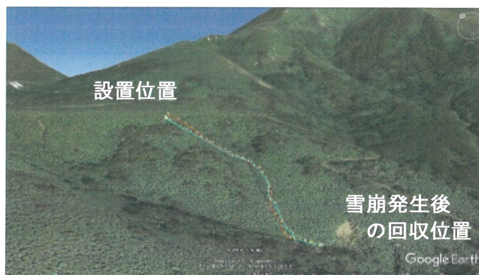
雪山での設置状況と落下漂流時の軌跡(GPSデータ)
