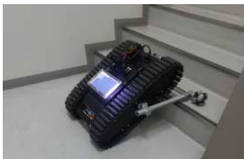
図1 コの字型アームによる車体の持ち上げ
