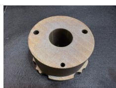
水冷管を付与した金型
