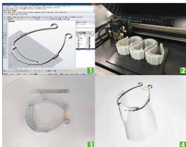
[1] センターが改良した3Dデータ [2] 3Dプリンタによる造形の様子 [3] 試作品 [4] 完成品
