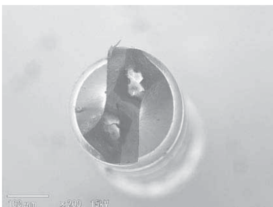
図5 TiAlN コートドリルの磨耗および溶着の状況
