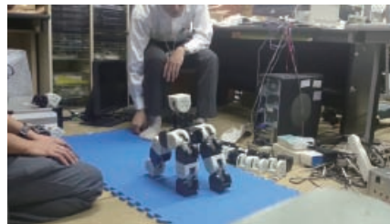
合体変形ロボットM-T R A N IIIの操作
