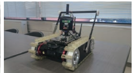
装置を小型移動検査ロボットDIR-3に搭載
