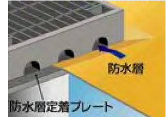
高機能排水マス (床版打換え時適用)
