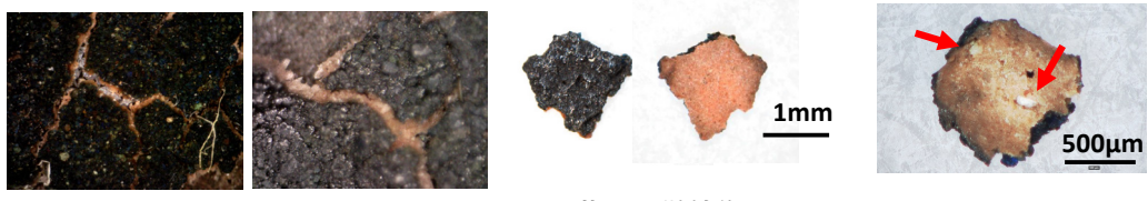
a. 像腕の剥落部位 b. 剥落片顕微鏡像（両面） c. 白色粒子が見られる剥落片
