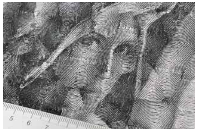
図 21 文様状の閾値サブマトリクスによる試織結果
