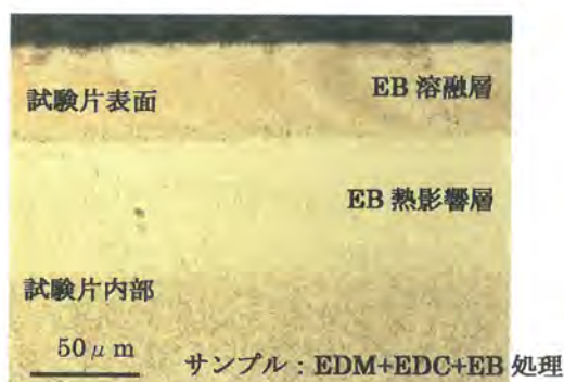
金属顕微鏡による試験片断面観察結果
