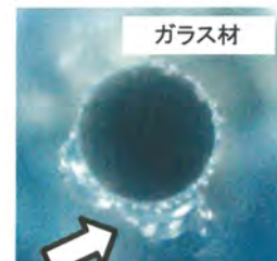
ガラス材 従来加工による不具合例 (穴縁部の欠け)
