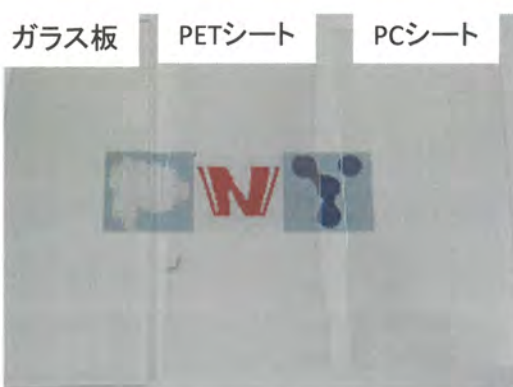
図2 各種基材に成膜した酸化亜鉛透明導電膜事
