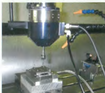
超音波振動装置を設置した切削加工
