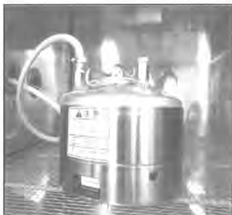
処理装置（恒温炉および耐圧容器）および圧力容器内での水熱処理
