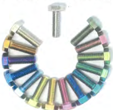
熱処理により様々に発色した六角ボルト・板 (ボルト:上部が処理前・外周が処理後、板:左上が処理前)
