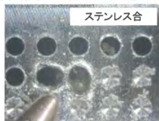
ステンレス合 従来加工による不具合例 (工具折損)
