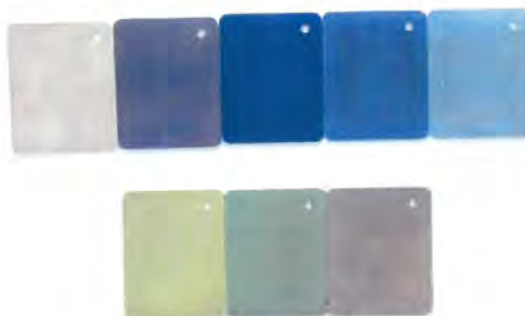
熱処理により様々に発色した六角ボルト・板 (ボルト:上部が処理前・外周が処理後、板:左上が処理前)
