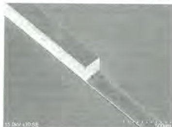
転写用マイクロ金型(幅0.2mm, 高0.2mm)
