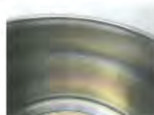
ステンレス製鍋の酸化皮膜
