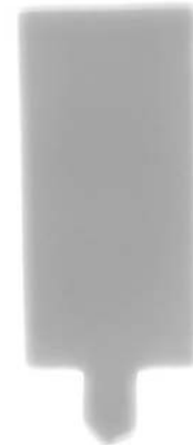
図5 鋳造したパラジウム合金のマイクロフォーカスX線透視装置による観察画像例 (配合No.12)
