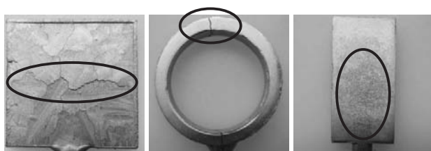
図4 鑄造欠陥が発生したサンプル
