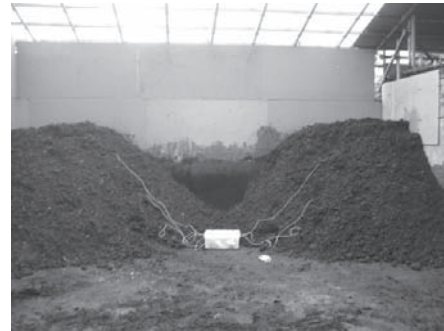
図2 堆肥の堆積と温度計設置(3点で測定)
