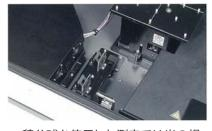
積分球を使用した測定では光の損 失が大きいため、感度を重視した測 定を行う場合には、直接受光ユニッ トを使用します。主に液体試料やフィ ルム試料の測定に用います。
