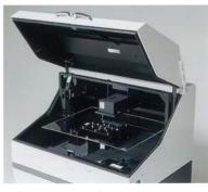
幅700mm×奥行560mm×厚さ 40mmまでの大型試料の透過測定が 可能です。
