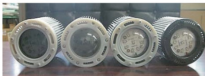
図4 使用したLEDライト (試験2) (左から赤, 緑, 青, 購入時のライト)
