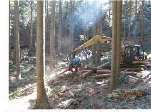
高性能林業機械による伐倒作業のデモンストラーション
