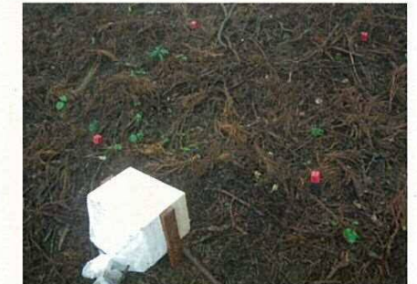
土砂受け箱設置状況
