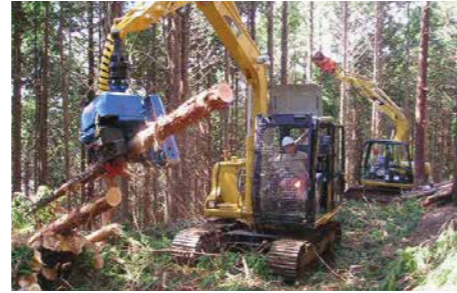
高性能林業機械による間伐材の搬出作業
