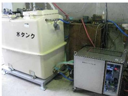
図1 ファインバブル水発生装置
