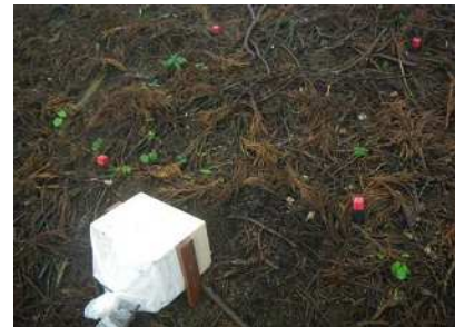
土砂受け箱設置状況
