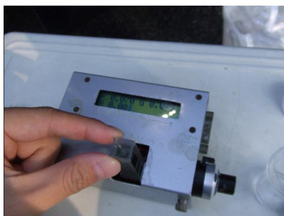
図1 小型比色計による吸光度の測定
