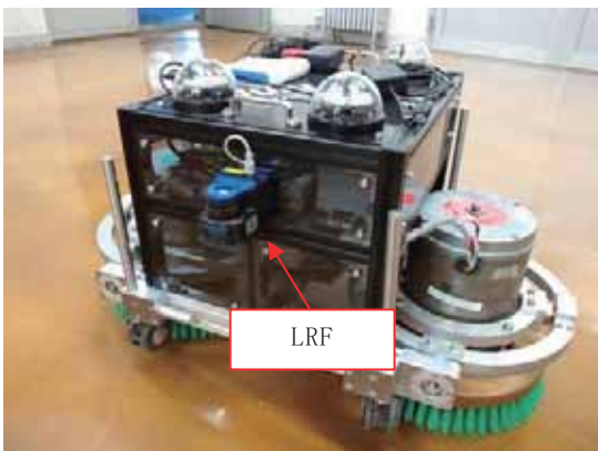
Fig. 9 LRF の取り付け位置
