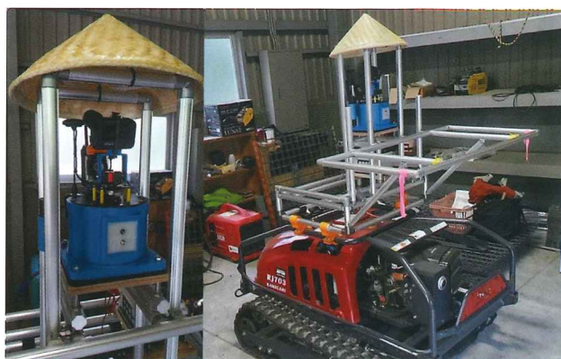
写真 3 遠隔操作カメラ搭載ラジコン草刈機
