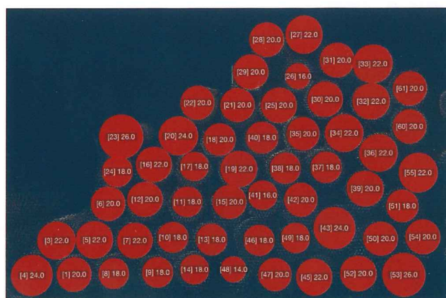
図 1 LiDar センサーによる木口の位置と径の検出
