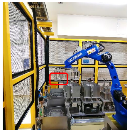
ロボットが製品の入った容器（ワーク）を運ぶ様子
