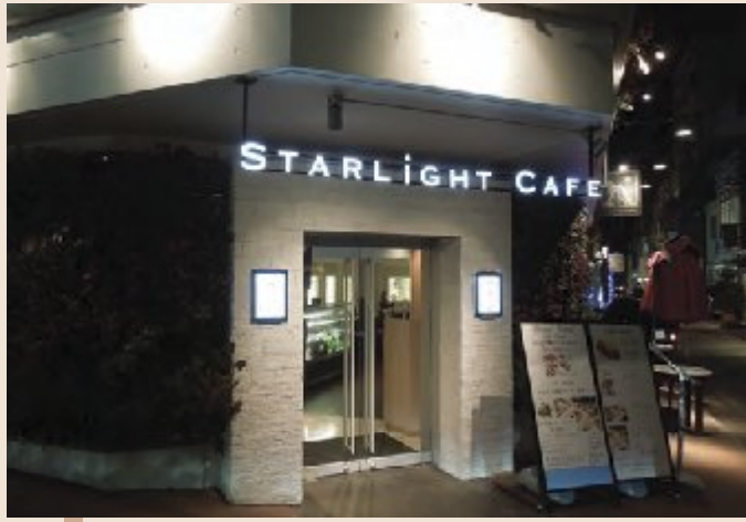
文字のみが光る構造のため、不要な部分に光が当たらない照明
