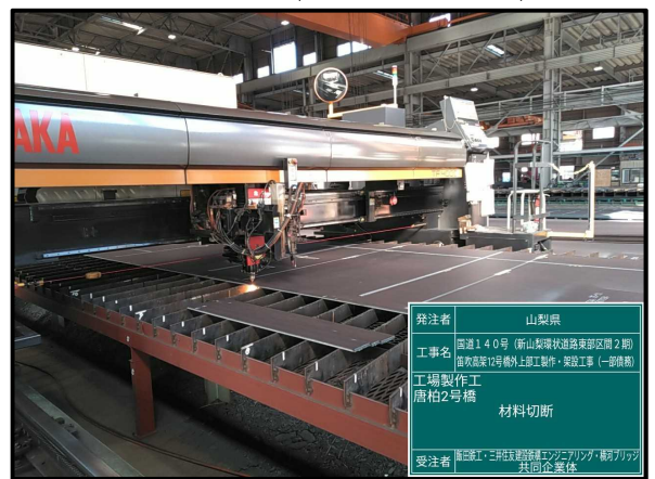
施工状況(鋼板材料切断)
