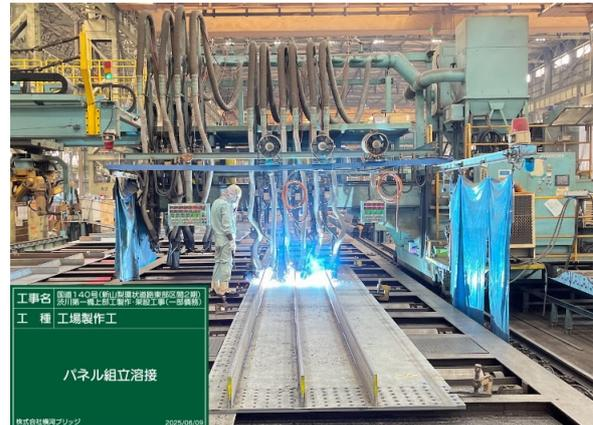
橋形式：鋼2径間連続鋼床版箱桁橋
