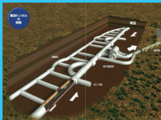
雁坂トンネル内部構造
