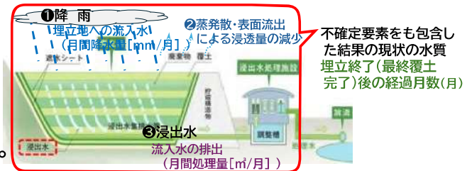
図3.1.2 浸出水水質へ影響を与える水の挙動
