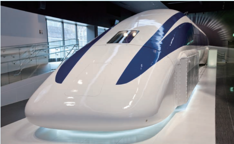
2003年(平成15年)に当時の世界最高速度581km/hを記録した試験車両MLX01-2。現在は山梨県立リニア見学センターどきどきリニア館1階に展示されている。(都留市:山梨県立リニア見学センター)
