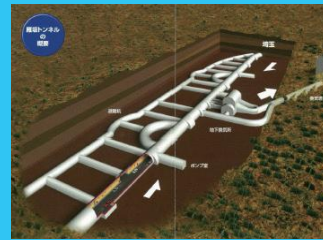
雁坂トンネル内部構造
