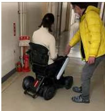
図1 ロボット用ミドルウェアROS2により制御可能な電動車いす
