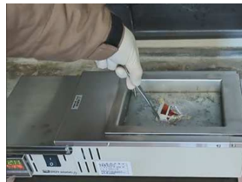
図2 はんだ耐熱性評価の様子
