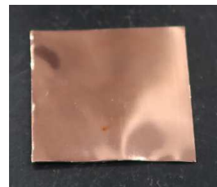
図4 評価後のPTFE基板 (左: はんだ耐熱性, 中: 耐薬品性 (塩酸), 右: 耐薬品性 (NaOH水溶液))
