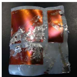
図4 評価後のPTFE基板 (左: はんだ耐熱性, 中: 耐薬品性 (塩酸), 右: 耐薬品性 (NaOH水溶液))
