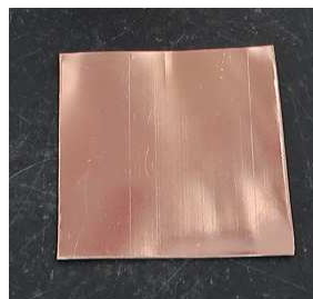
図4 評価後のPTFE基板 (左: はんだ耐熱性, 中: 耐薬品性 (塩酸), 右: 耐薬品性 (NaOH水溶液))
