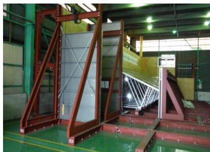
図 D4 左：試験体の設置例
