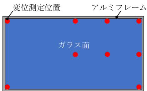
図 F7 正圧時の変位測定位置
