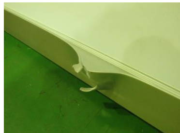
図 F13 モジュール固定用孔の破壊
