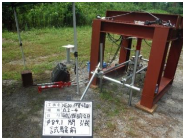
写真 G1-1 引抜載荷状況
