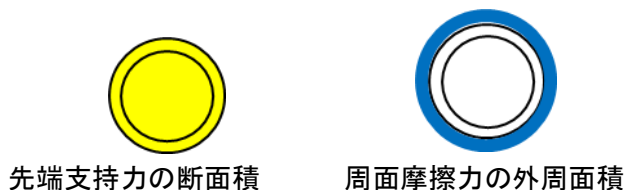
図 G1-2 支持力算出の面積（先端開放杭）
