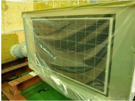
図 F5 漏気防止処理
