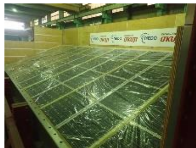
図 D4 右：漏気防止処置例（正圧時）
