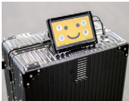
小型CO 2 回収装置「ひやっしー」 液晶に映る表情でCO 2 濃度を示してくれる
