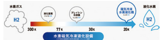
JST 未来社会創造事業:高効率水素液化機システムイメージ参照 JST-Mirai Program: See image of high-efficiency hydrogen liquefaction system
