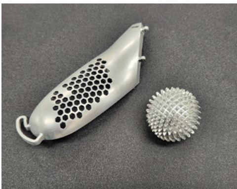
特注コントローラーカバーと三方向自由回転「球状歯車」 Custom-made controller cover and three-way free-rotating spherical gear
