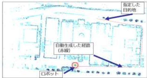
図6 自動運転用地図上に自動生成した経路
