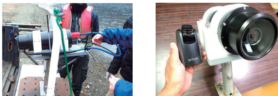
図1 水中ビデオカメラシステムの概観 (左: 設置時の様子, 右: ハウジングに収容されたネットワークカメラ (SONY, SNC-VB640), タイムラプスカメラ (BRINNO, TLC200 Pro))
